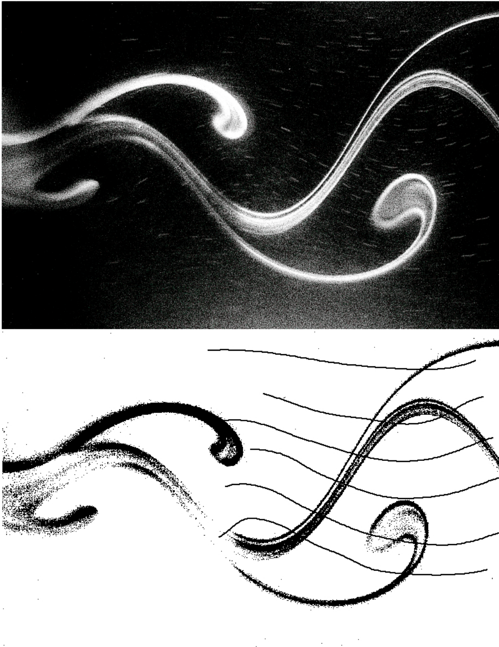
Figure 6 : Ecoulement instationnaire derrière un cylindre *
